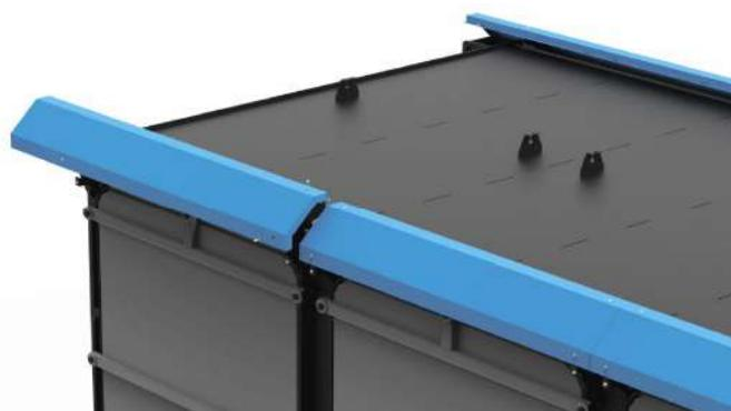
Рисунок 9. Демонтаж угловой обшивки котла
